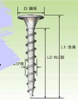
「板金野地板ビス」は木下地用の薄鉄板直止め用ビスで、横葺き屋根材やスパンドレル、金属サイディングの直止めなどに適しております。材質がラスパルト処理の軸径3.8mm×2.5mmと3.0mmの2サイズをご用意いたしました。
